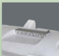
Zusätzliche Frischluftzufuhr: mit einstellbarer Dach-Entlüftung.
